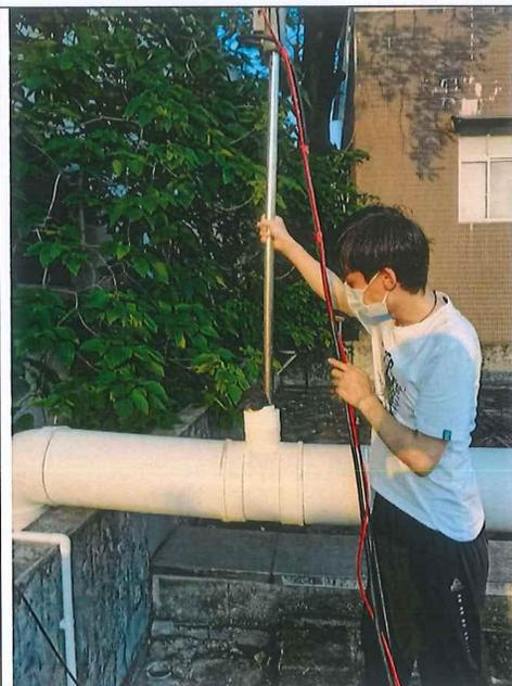
图 9.4 实验室废气处理前检测口 ◎Q1
